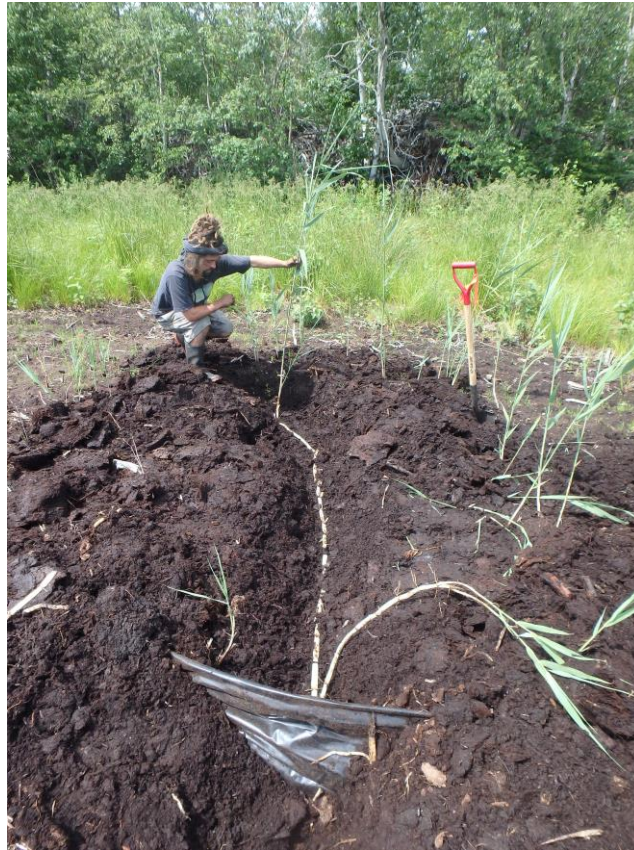
Figure 1. Rhizome de roseau commun en sol organique s'étant étendu au-delà de la surface d'une géomembrane enfouie sous 1 m de sol. Il n'a suffi que de quelques semaines au cours de la saison de croissance ayant suivi l'enfouissement de la géomembrane pour que l'on observe ce phénomène (photographie : F. Messier).
